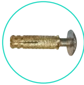
Anclaje escamoteable de dos piezas: taco latón y tornillo inox. Long. 35 mm, Diám. 10 mm, rosca M-8
