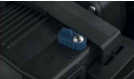
Interruptor SFC En las AquaMax Eco Premium 5000-21000. Con el sistema SFC (Seasonal Flow Control) conectado, la bomba regula de manera óptima y automática el caudal de agua y la altura de bombeo, y reduce hasta un 50 % el consumo.
