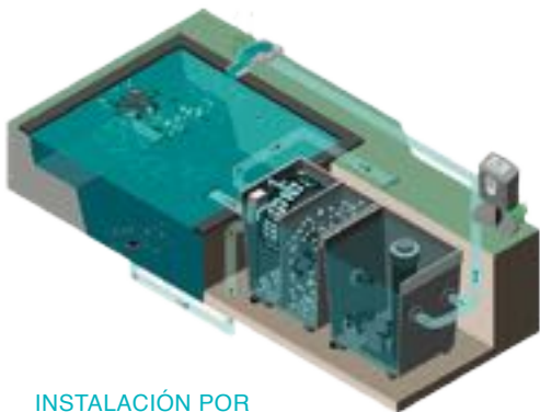
INSTALACIÓN POR GRAVEDAD
