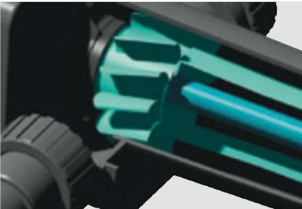
Rotor de limpieza: Impulsado por el caudal de agua,el rotor de limpieza gira continuamente en torno a los tubos de cuarzo y evita así que se formen sedimentos.
